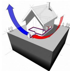
La aerotermia se basa en extraer el calor, o mejor dicho, la energía gratuita existente en el aire exterior, y le cede al agua que se aporta al sistema de calefacción y/o agua caliente sanitaria.
