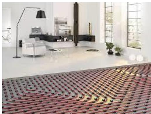
La instalación consiste en una red de tubos multicapa o similar, sobre placas de aislamiento térmico, que se instalan debajo del pavimento y de una capa compresora de mortero, por donde circula agua caliente a una temperatura de entre 30°C y 40°C.
