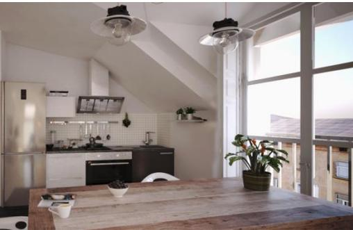
El **acristalamiento** estará realizado por vidrio aislante de control solar bajo emisivo, que consta de dos vidrios de seguridad de 3+3 mm de espesor y un vidrio de 6 mm, separados por una cámara de aire deshidratado, de 12 mm de espesor, que le confiere unas óptimas propiedades de aislamiento térmico y acústico.
