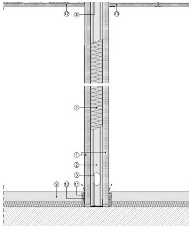
Medianeras entre viviendas, se realizará con ladrillo perforado de 11 cm trasdosado por ambas caras y aislamiento acústico sobre perfilería con panel de yeso laminado tipo Pladur o similar.
